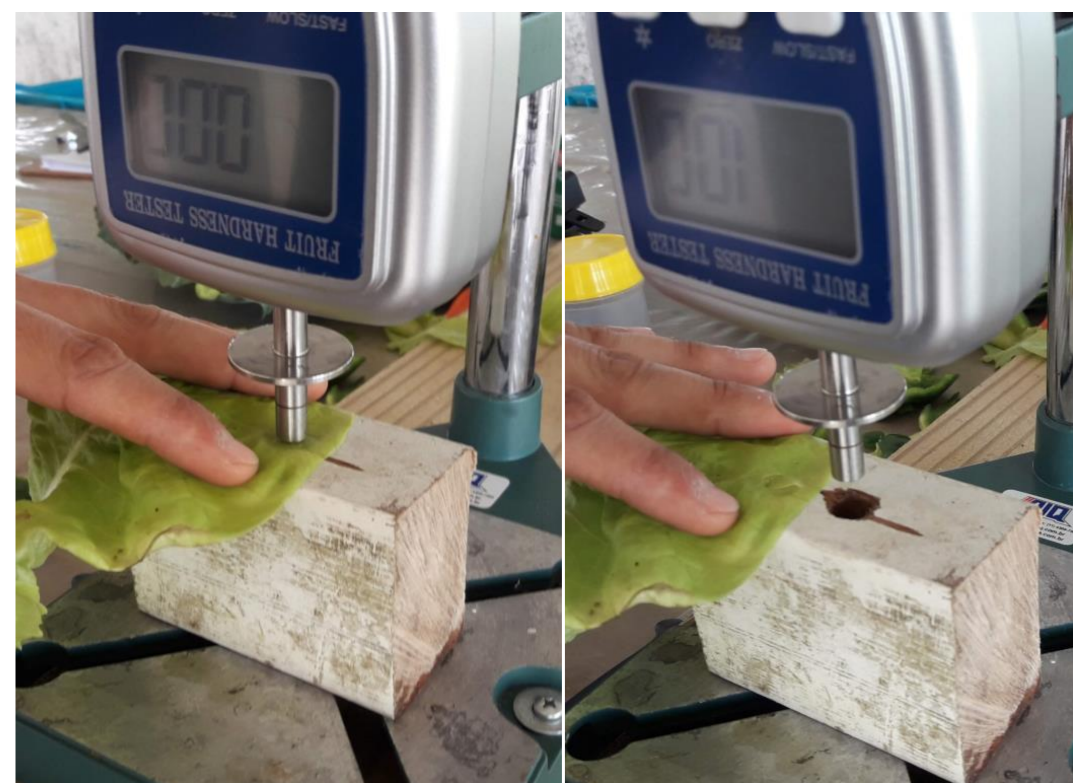
Figura 1. Método utilizado para determinar a firmeza de folhas de alface, com o auxílio do penetrômetro digital Soil Control/USA, modelo PDF-200.
