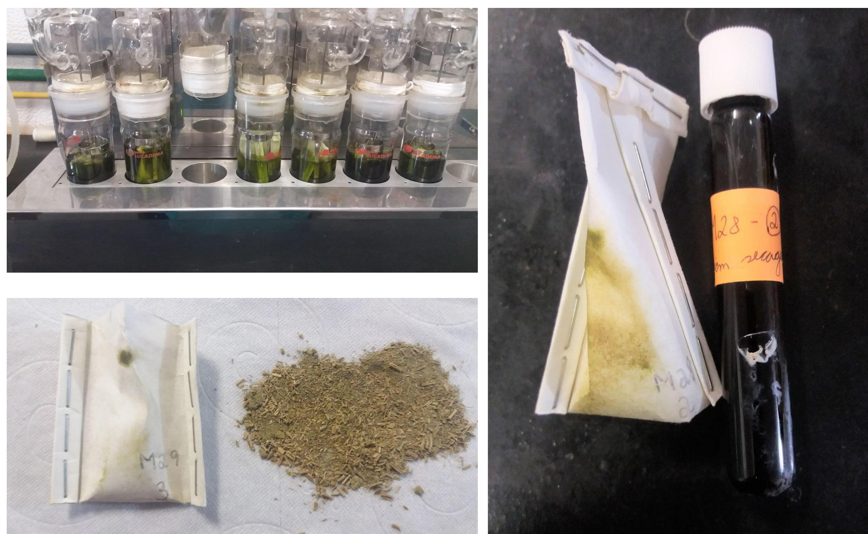
Figura 1. Extração do óleo essencial por Soxhlet e armazenamento do mesmo após a extração. Araras, 2019.
