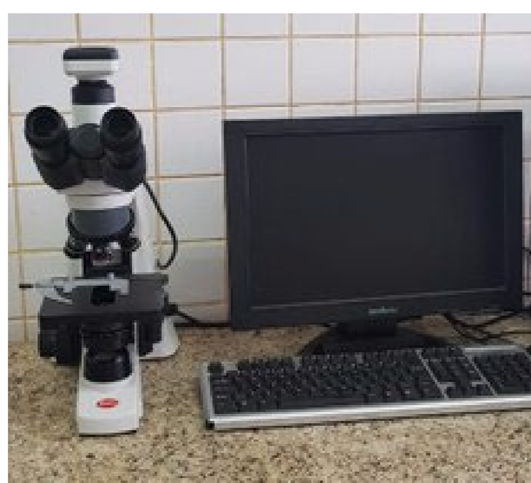
Fig. 1: Microscópio óptico (Motic BA 210) com câmera acoplada (Moticam 5).
