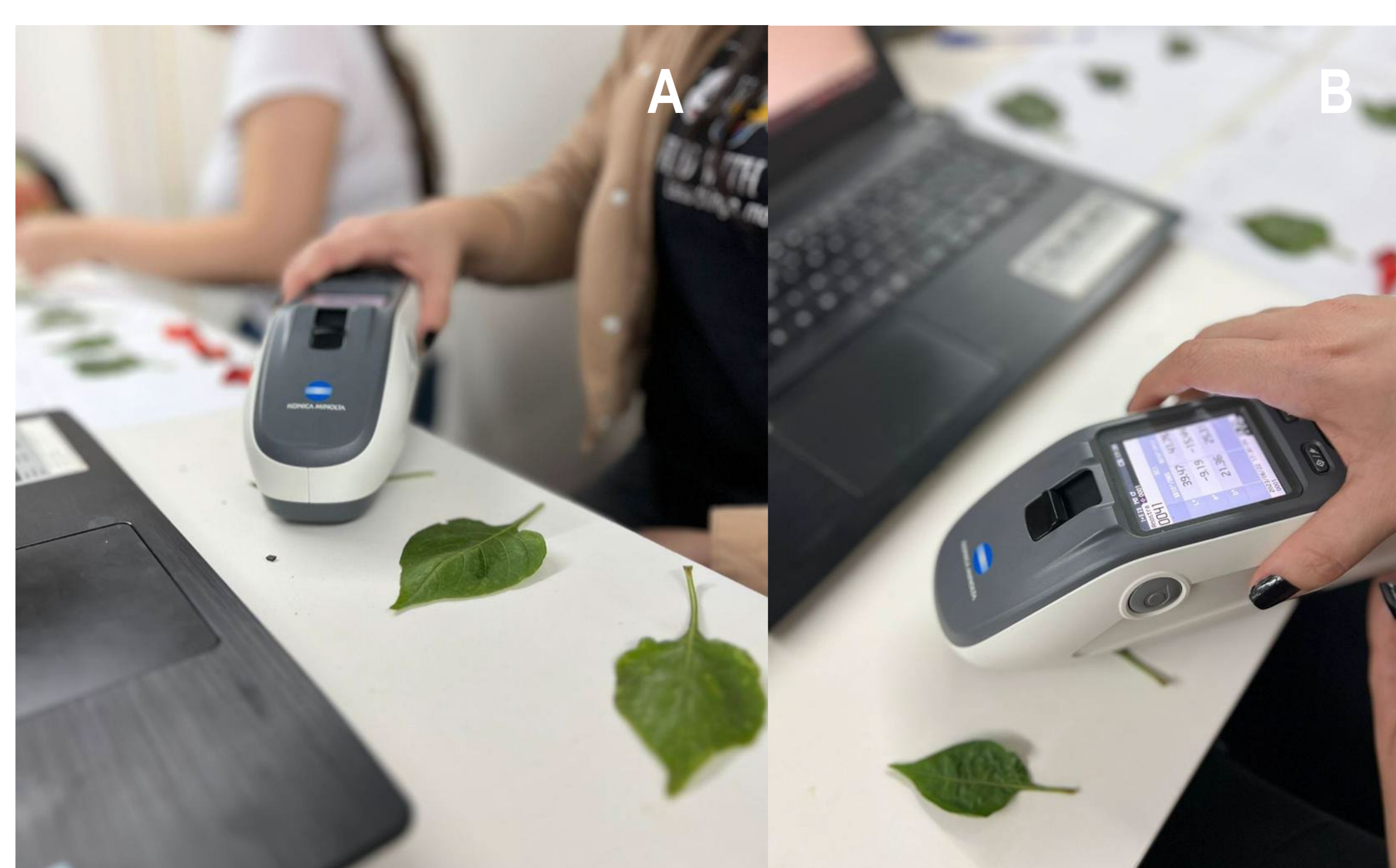
Figura 1-A e B – Análise instrumental realizada utilizando o espectrofotômetro CM-25d (Konica Minolta®) em plantas de biquinho vermelha tratadas com PBZ.
