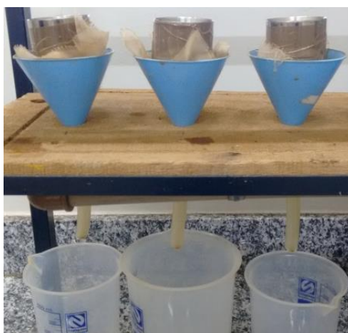
Figura 3 - Condutividade hidráulica foi obtida através da aplicação da equação de Darcy, ou quando os valores atingem a estabilidade.
