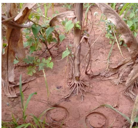
Figura 2 - Coleta das amostras indeformadas de solo no horizonte superficial na cultura do milho para análises de atributos físicos.
