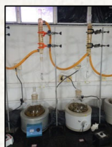
Hidrodestilação (75g + 2,0L água)
