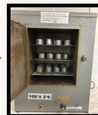
Determinação do grau de umidade (GU) em estufa a 105 °C.
