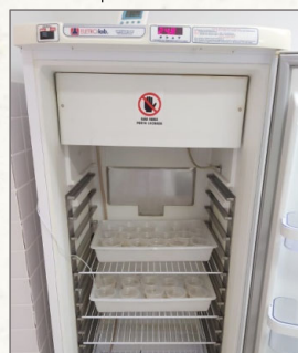
Depois foram levadas para incubadora tipo BOD por um período de 24 horas
