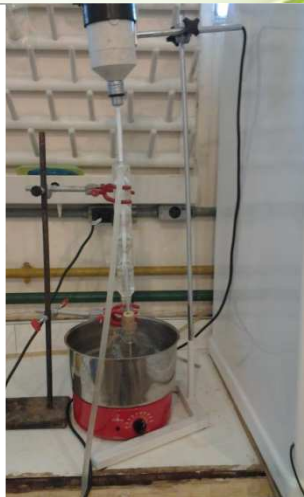
Figura 2 : Representação do aparato experimental, contendo um banho de aquecimento, um balão, condensador e agitador
