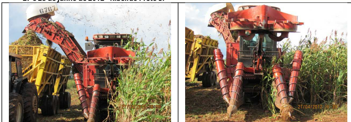
Figura 1. Colhedora Case 7700 colhendo sorgo sacarino no espaçamento de 0,90m. Aparecida do Tabuado, MS, 2012.
