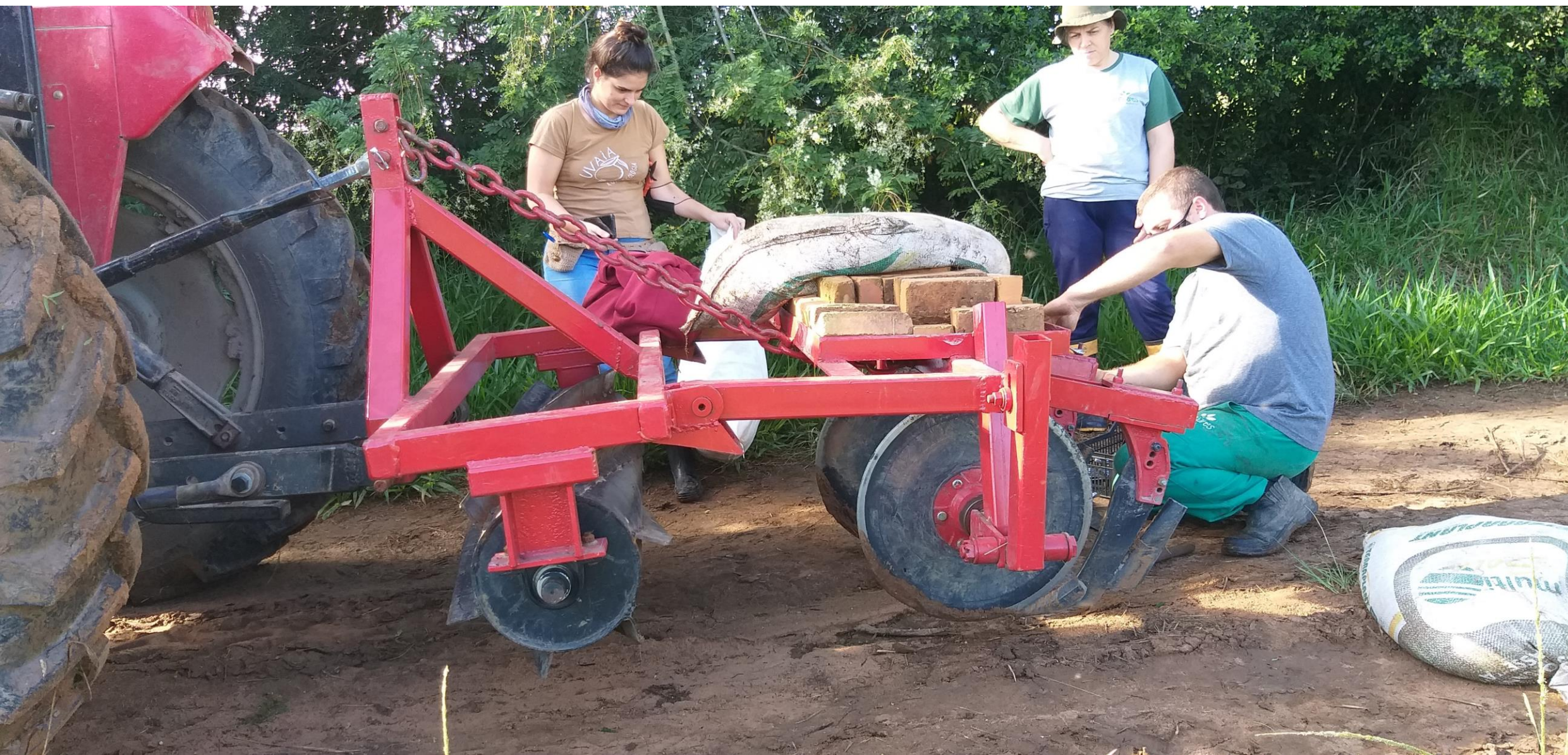
Figura 1. Implemento desenvolvido para realização do acamamento físico de plantas de cobertura em sistema de plantio direto de hortaliças. Consiste em um rolo faca, dois discos de corte e dois sulcadores.
